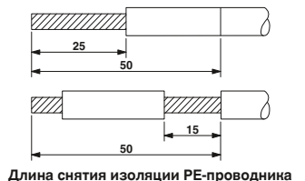
Длина снятия изоляции РЕ-проводника
